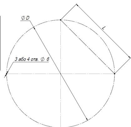
Розмітити точки на поверхні монтажу згідно габариту світильника. Просвердлити отвори.
