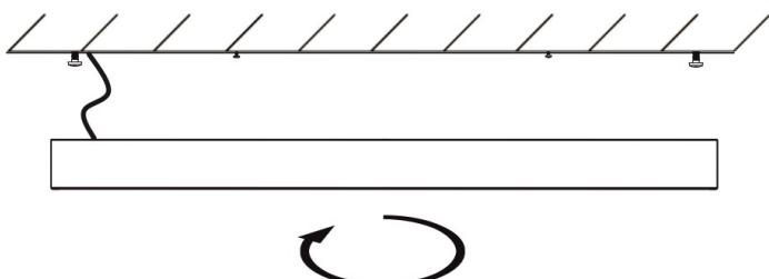
Помістити клемник з підключеним проводом у нішу в світильнику. Навісити світильник, прокрутити за год. стрілкою.
