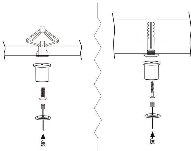
Протягнути троси крізь кронштейни підвісів. Встановити кронштейни на поверхню. У випадку заміни тросу на інший, він має бути без ізоляції та Ø 1 мм.
