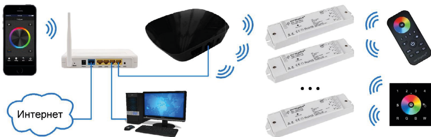
Рис.3. Подключение через роутер с использованием проводного соединения.
